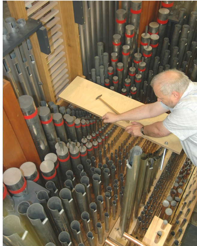
Orgelbaumeister Hubert Fasn beim Stimmen der Pfeifen im Hauptwerk. Hier sind am Ende der Intonationsarbeiten schon alle Pfeifen eingebaut.
